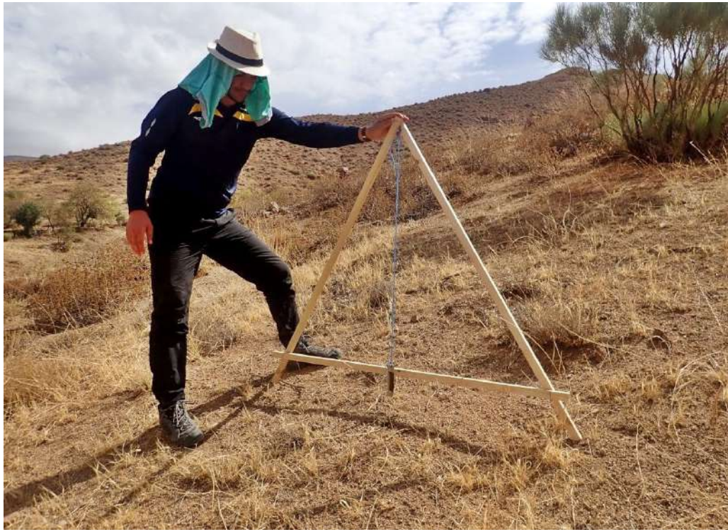
Niveau égyptien et son utilisation pour tracer des courbes de niveau
