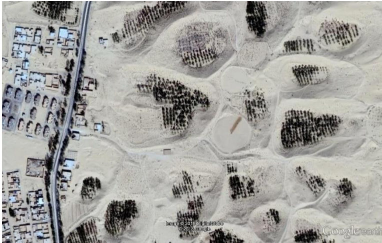
Figure 17 : les palmeraies du Souf reposent sur des cuvettes confectionnées pour tirer profit de la nappe phréatique : c'est la technique du Ghout (l'entonnoir).
